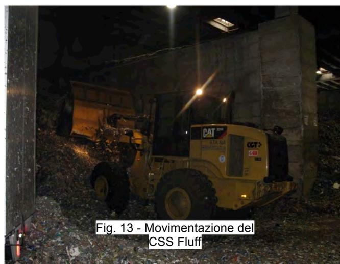
Successivamente il CSS Fluff viene movimentato attraverso l'ausilio di una pala gommata e caricato nella bocca di carico del sistema di nastri trasportatori per l'alimentazione della centrale.
