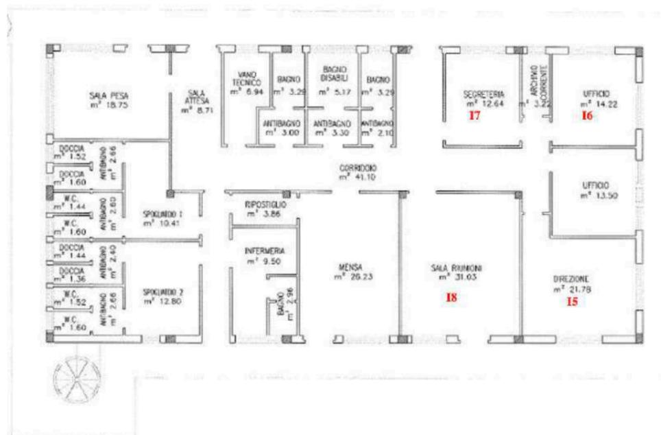
Fig. 9 Planimetria intera fabbricato turbogeneratore e palazzina uffici, con punti di misura dei campi elettromagnetici
