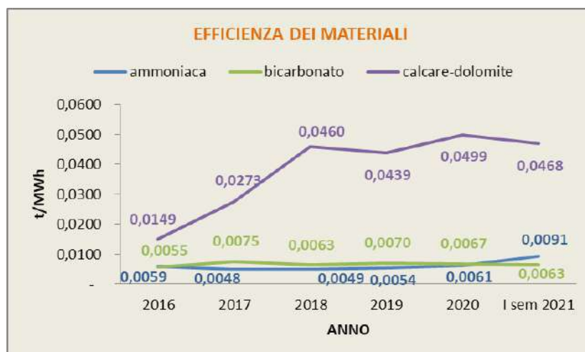
Grafico 13: Efficienza ammoniaca, bicarbonato, calcare dolomite
